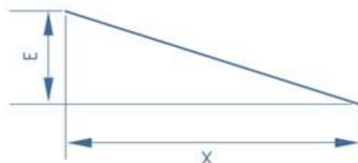
Figura 10 – Simbologia relativa alla tolleranza di planarità
